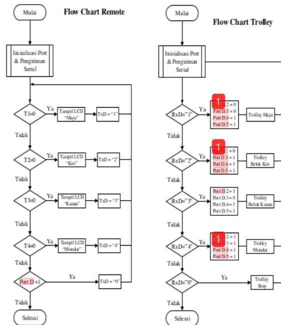
Gambar 4 Diagram alur perangkat lunak pada bagian pengirim
