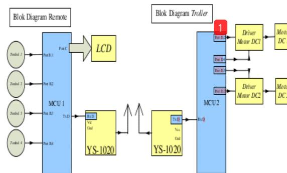
**Gambar 1 Diagram blok rangkaian sistem kontrol elektronik**
