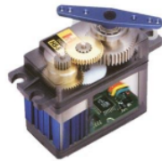
Gambar 1. Susunan komponen motor servo [1].
