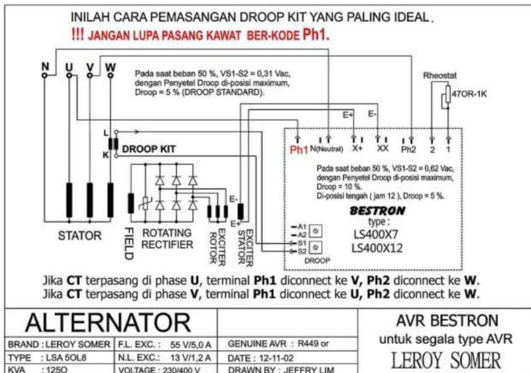
Gambar 2.3 Circuit diagram dari AVR [6].
