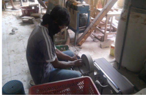
Gambar 3. Postur Awal Operator Stasiun Kerja Amplas Mesin.
