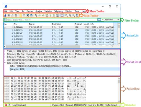
Gambar 5. Struktur Wireshark
