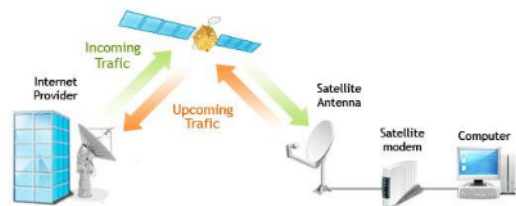
Gambar 1. Cara kerja satelit secara umum
