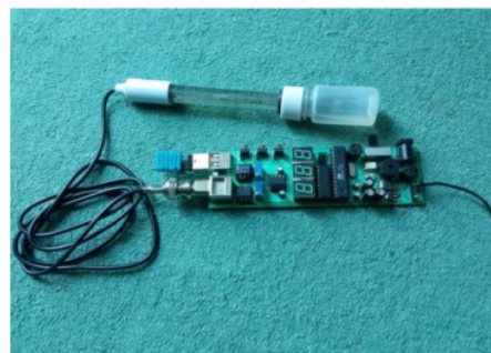
Gambar 6. prototipe dari rancang bangun alat ukur pH, suhu dan kelembaban dengan media tanam jamur tiram
