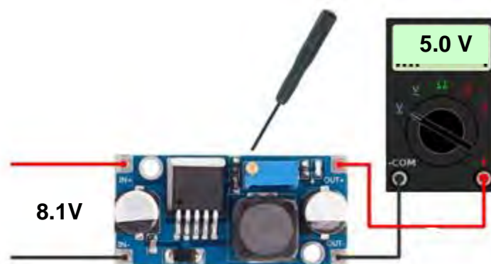
Gambar 4.3 Teknis mengatur tegangan keluaran dari modul LM2596
